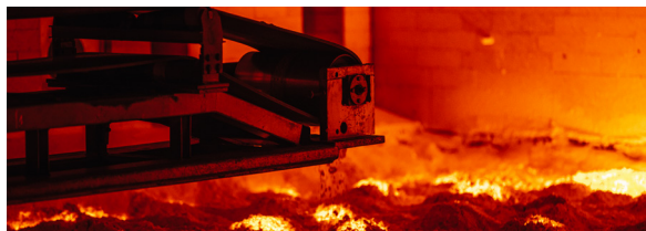
(640A3503) Automatisierte Zugabe von Rohmaterial in die DURAN™ Glasschmelzwanne
